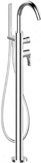
ART. B080B+R080A Gruppo vasca da pavimento, interasse bocca 20 cm, deviatore a pulsante a 2 uscite / Cartuccia tradizionale. Floor-mount bathtub mixer, spout projection 20 cm, 2-way diverter with pushing button / Traditional cartridge. Mélangeur bain-douche installation au sol, entraxe bec 20 cm, inverseur 2 sorties avec bouton / Cartouche traditionnelle. Bodenstand-Wannenmischer, Achsabstand Auslauf 20 cm, Umsteller mit Drucktaste 2-Wege / Standardkartusche. Batería bañera a suelo, distancia a chorro 20 cm, desviador con pulsador 2 salidas / Cartucho tradicional.
