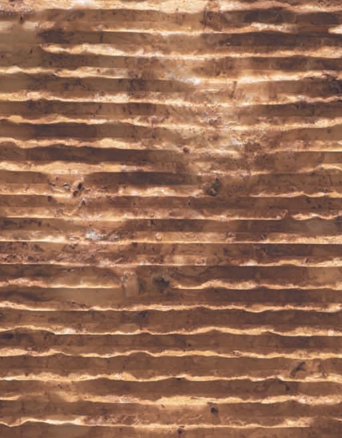
Lavorazione “vergata” Vaselli in travertino dorato caratterizzata dalla rottura manuale delle lamelle in rilievo.
