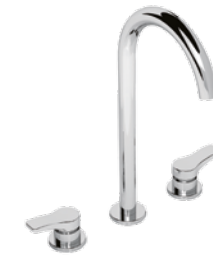
ART. B206WF Gruppo lavabo alto 3 fori, interasse bocca 16 cm, senza scarico / Vitoni ceramici. 3-hole high washbasin mixer, spout projection 16 cm, without waste / Ceramic cartridges. Mélangeur lavabo 3 trous bec surélevé, entraxe bec 16 cm, sans vidage / Têtes céramiques. 3-Loch-Waschtischmischer hoch, Achsabstand Auslauf 16 cm, ohne ablauf / Keramikoberteil. Batería lavabo alto 3 elementos, distancia a chorro 16 cm, sin desagüe / Cartuchos de disco cerámico.
